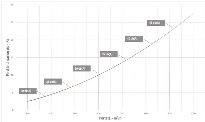
Perdite di carico statiche relative a diffusori completi di plenum in esecuzione standard
