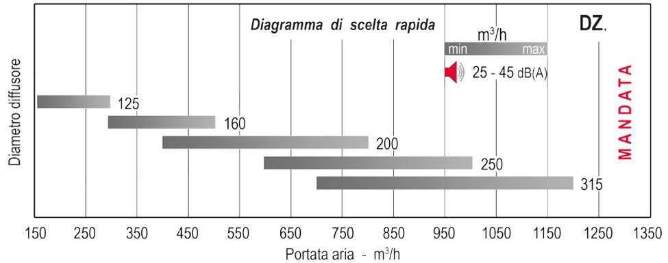
Il valore consigliato della velocità dell'aria attraverso la superficie effettiva deve essere adatto ad un lancio medio con velocità finale in ambiente comunque inferiore a 0,3 m/s, per un livello di potenza sonora compreso tra 25 dB(A) e 45 dB(A).
